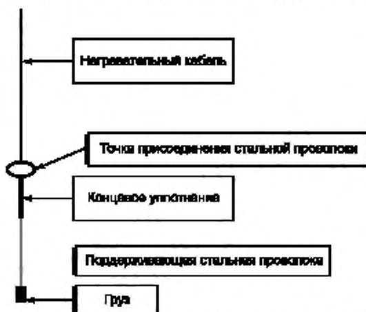
Рисунок 2 – Типовое расположение элементов при испытании концевое уплотнения
