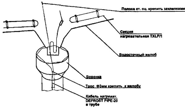
**Рис. 6** Узел крепления одной нитки саморегулирующихся нагревательных секций в водосточной воронке
