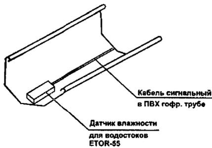
*Рис. 5 Узел установки датчика влажности в водостоке*
