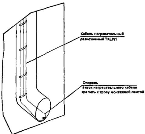
**Рис. 3** Узел крепления двух ниток резистивного нагревательного кабеля с тросом внизу водосточной трубы
