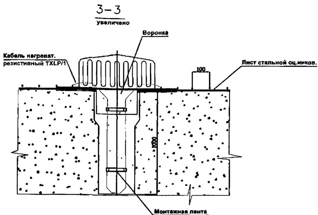
**Рис. 9** Узел крепления резистивного нагревательного кабеля в водосточной воронке
