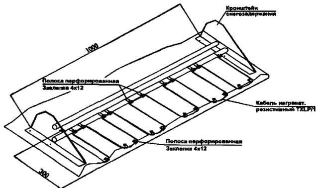
**Рис. 8** Узел обогрева карниза кровли резистивным нагревательным кабелем
