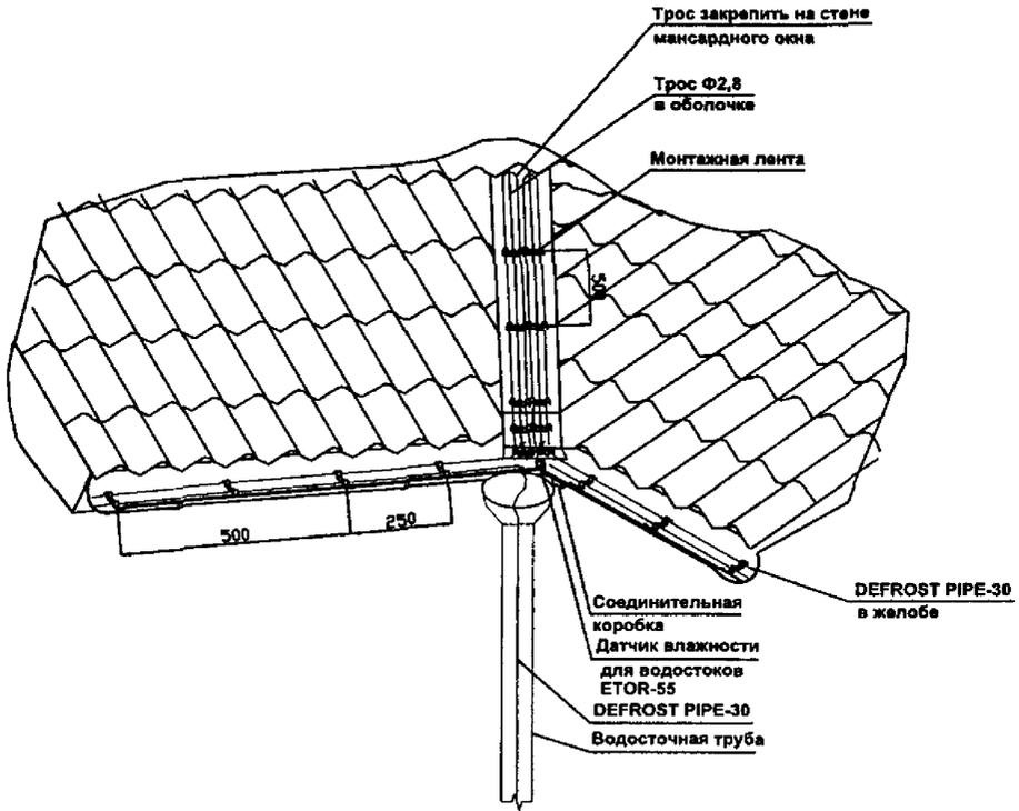
*Рис. 4 Узел крепления в желобах, воронке и ендове саморегулирующихся нагревательных секций*
